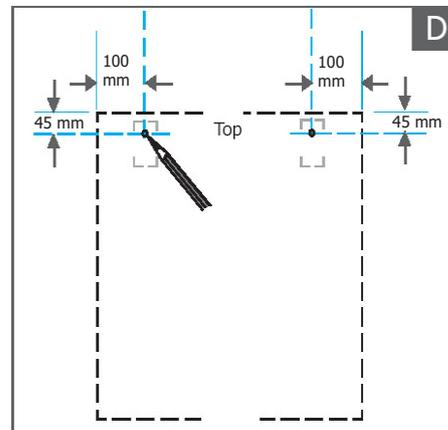
**D** Positionierung und markierung der Bohrstellen.
