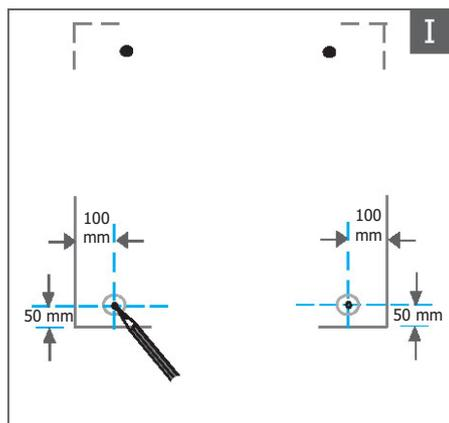
Jetzt die 6mm Löcher einbohren wie angedeutet.
