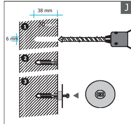
Bohren Sie das Loch um 30 mm tief und platzieren Sie den mitgelieferte Dübel und befestigen Sie die untere «Clip» an der Wand.
