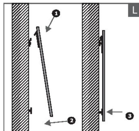
Objekt in obere Haken einhaken und unten auf den selbstklebenden «Clips» festdrücken. Zu letzt entfernen Sie den Schutzecken.
