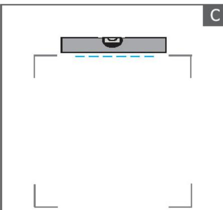
**C** Prüfen Sie mit Wasserwaage ob Markierung völlig waagrecht ist.
