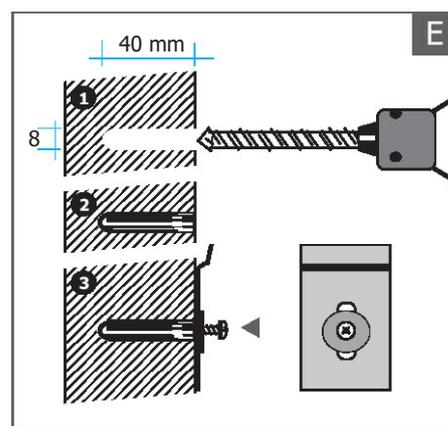
**E** Die Löcher(8mm) um 40 mm. tief einbohren, mitgelieferte Dübeln platzieren und Aufhänge haken mit Rondell oben drauf befestigen.
